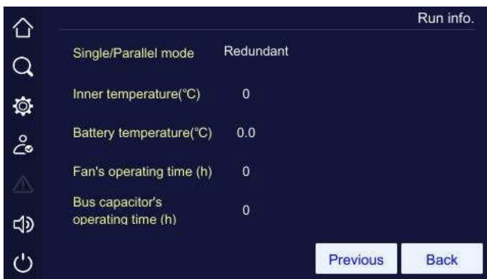
Pagina 2 stato di funzionamento (UPS parallelo)
