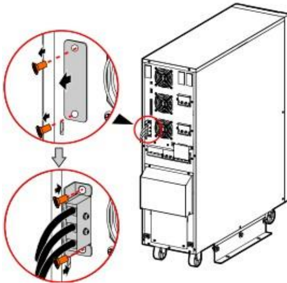
Assieme cablaggio batterie di estensione
